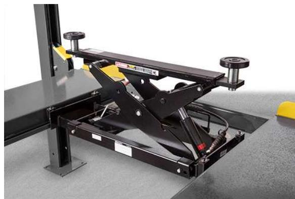
rampas y posicionarse bajo los puntos clave de elevación del vehículo. Con un par de gatos puente rodante usted podrá levantar fácilmente su carro. Nuestros gatos RJ-7 vienen equipados con una bomba hidráulica de uso comercial y requieren una presión de 125 PSI y 10-20 CFM.
